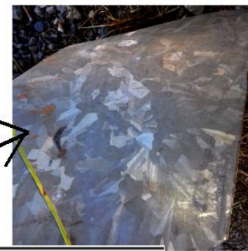
Πολυκρυσταλλικό κράμα (διακρίνονται διαφορετικές κρυσταλλικές περιοχές)
