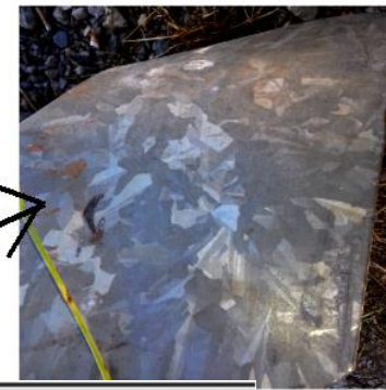
Πολυκρυσταλλικό κράμα (διακρίνονται διαφορετικές κρυσταλλικές περιοχές)
