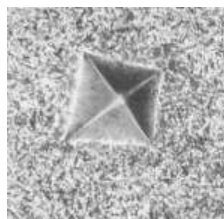
Αποτύπωμα μέτρησης Vickers Dennis M. Clarke/ Wikimedia Commons / CC-BY-SA-3.0
