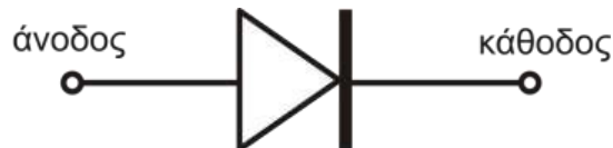
γραφική απεικόνιση p-n διόδου σε ηλεκτρικό κύκλωμα
