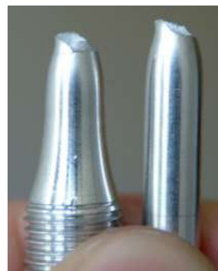
Μεταλλικό δοκίμιο μετά το τεστ μηχανικής αντοχής
