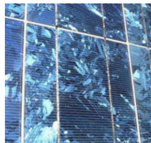
Φωτοβολταικά με πολύκρυσταλλικο πυρίτιο
