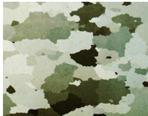
Πολυκρυσταλλικό κράμα Fe-Si
