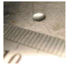
Αποτύπωμα μέτρησης Brinell User:IGW/ Wikimedia Commons / CC-BY-SA-3.0
