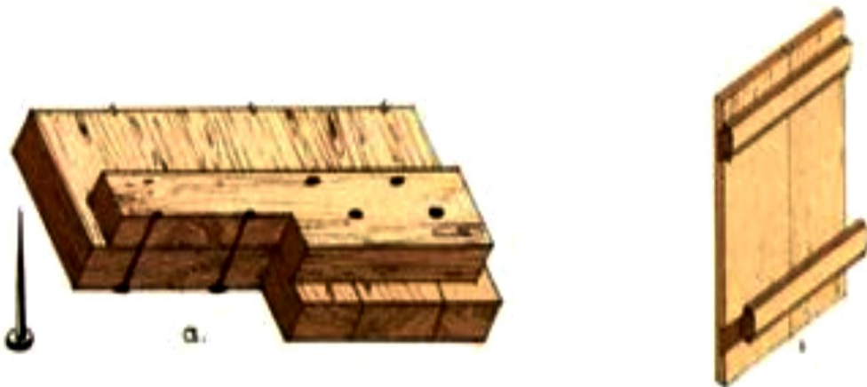
Σύνδεση τμημάτων ξύλου α) με ξύλινες καβίλιες β) με ξύλινες «πεταλούδες».
