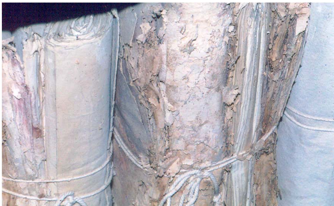
Εικόνα 5: Ο σπάγκος της περιδέσεως προκαλεί ανεπανόρθωτη ζημιά σε ευαίσθητο υλικό
